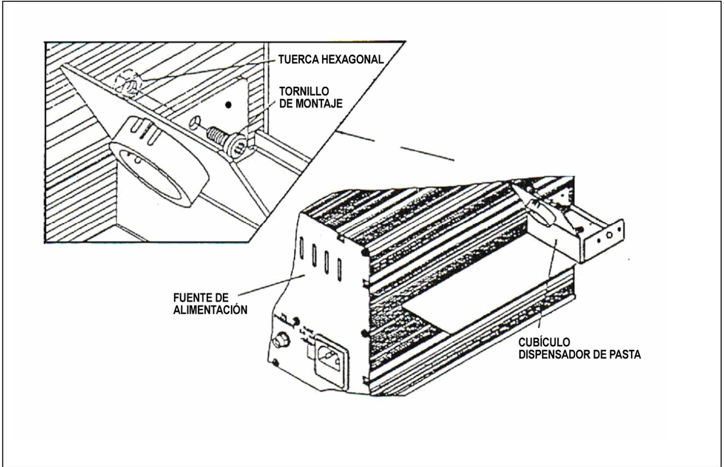
Figura 2. Acoplamiento del cubículo dispensador de pasta a la fuente de alimentación
