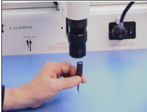
Figura 10. Instale la sonda rígida
