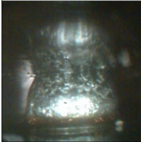
Exceso de fundente que quedó en la base de la bola de soldadura después del reflujo
