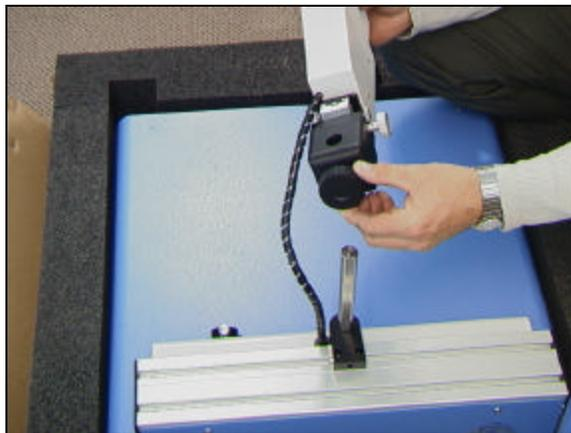
Figura 4. Afloje el tornillo de ajuste grueso
