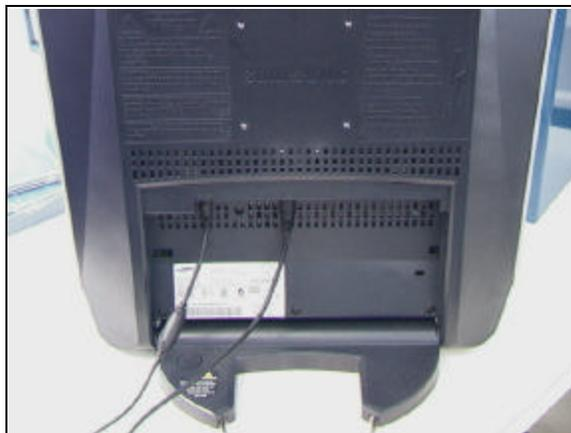
Figura 7. Conecte los cables de alimentación y de vídeo a la parte posterior del monitor
