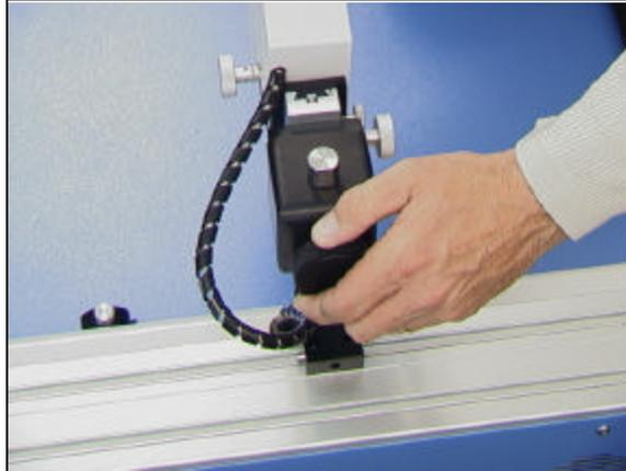
Figura 5. Coloque la unidad de cabeza de la cámara en el poste de la cámara
