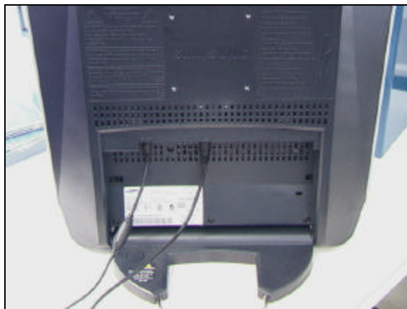
Figure 7. Câbles d'alimentation et vidéo branchés à l'arrière de l'écran
