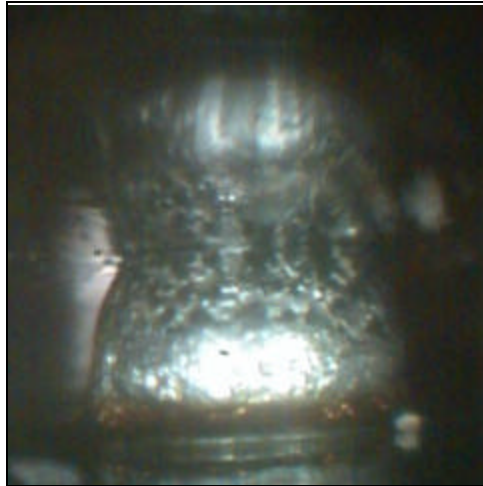
Flux excessif restant dans la partie inférieure de la bille de soudure après le brasage
