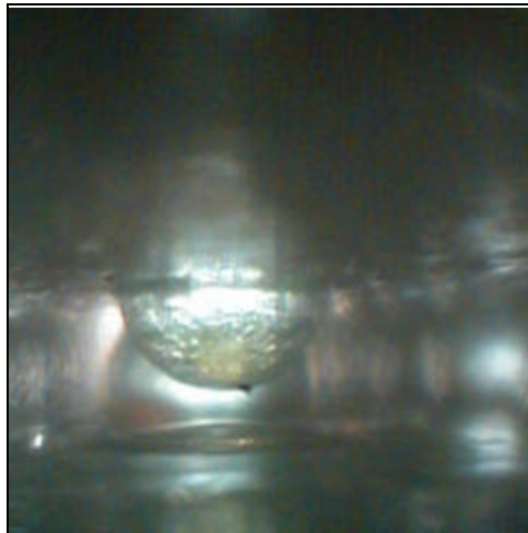
Connexion ouverte entre la pièce et la PCB.
